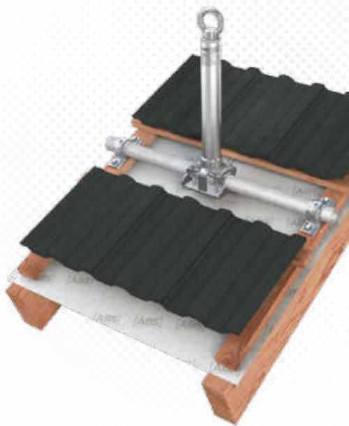
>>> Edelstahl-Anschlagpunkt für Holzsparren, mit verschweißtem Stützrohr (Ø 42mm) und Querrohr. Stützrohr in 2 Längen erhältlich (300 o. 400mm). Einfache Abdichtung mit Antennenziegel (nicht im Lieferumfang). Befestigung am Untergrund mit 4 Edelstahlschrauben. Inkl. Befestigungsset.
