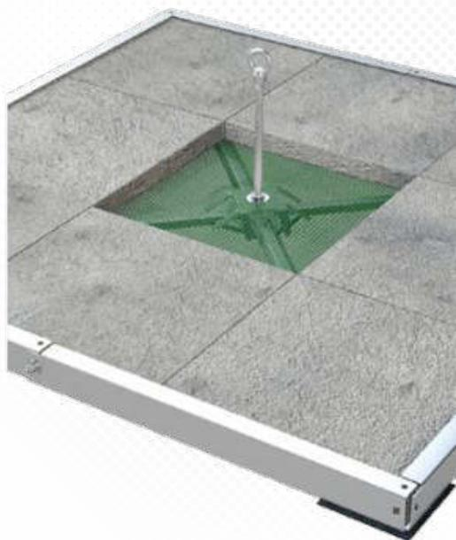
>>> Anschlagkreuz für Flachdächer, mit 8 Betonplatten (50 x 50 x 5cm) beschwert (nicht im Lieferumfang). Hochwertiger Edelstahl-Rahmen (150 x 150cm) mit Aluminiumquerstreben und zentralem Edelstahl-Anschlagpunkt (Ø 16mm). Inkl. Befestigungsset aus Edelstahl und 5 EPDM-Patches zum Schutz der Dachhaut.
