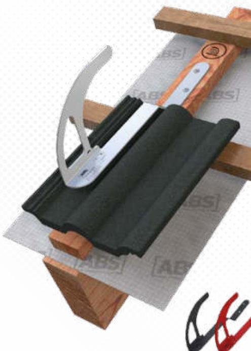
>>> Edelstahl-Sicherheitsdachhaken speziell für Ziegeldächer. Montage auf Holzsparren, mit gekröpftem Holm zur Überbrückung der Dachlattung. Befestigung mit 2 Edelstahlschrauben durch Konterlattung im Sparren. Auch in Rot (R), Anthrazit (A) oder Sonderfarben (X) erhältlich. Inkl. Befestigungsset.
