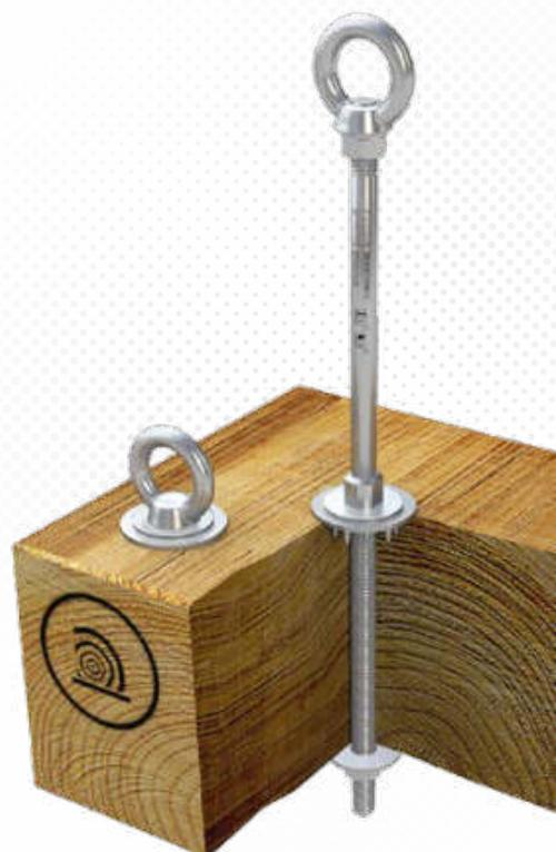
>>> Edelstahl-Anschlagpunkt (Ø 16mm) für Holz, nach Bohrung durch den Balken gesteckt und mit einer Mutter gekontert. Mit und ohne Überstand erhältlich. Inkl. Befestigungsset.
