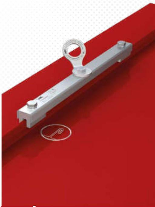
>>> Edelstahl-Anschlagpunkt mit Aluminiumklemmen oder Messingklemmen. Wird durchdringungsfrei auf Stehfalz oder Kupferstehfalz geklemmt. Besonders unauffällig. Inkl. Befestigungsset.
