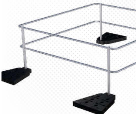
>>> Hochwertiges Schutzgeländer aus Aluminium und Edelstahl für Lichtkuppeln auf Flachdächern bis 10° Neigung. Durchdringungsfreie Montage mit Gewichten. Höhe des Handlaufs: 1100mm. Inkl. Befestigungsset.
