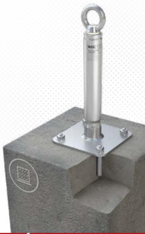
>>> Edelstahl-Anschlagpunkt für Beton, mit Grundplatte (150 x 150mm) und verschweißstem Stützrohr (Ø 42mm). 4 Ankerstangen werden mit Verbundmörtel WIT-VM-250 (ZU-1000) im Beton befestigt. Für nicht aufgeführte Betongüten erfolgt der Nachweis über Zugversuche. Inkl. Befestigungsset aus Edelstahl.
