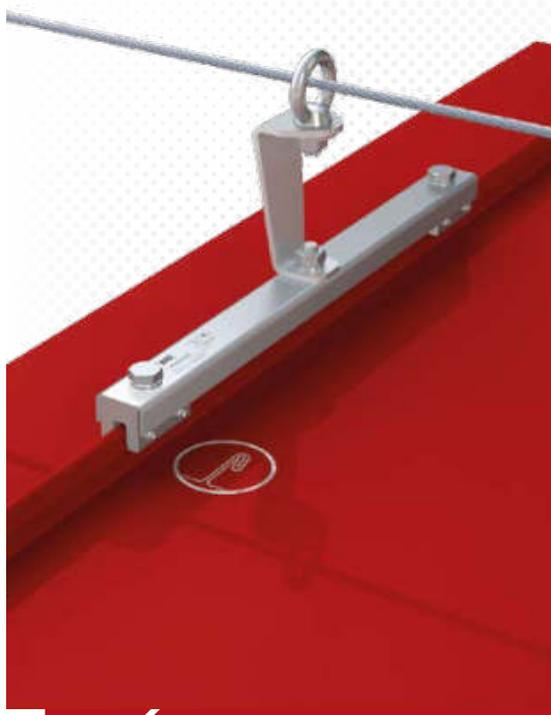
>>> Edelstahl-Zwischenhalter für Seilsicherungssysteme mit Aluminiumklemmen oder Messingklemmen. Wird durchdringungsfrei auf Stehfalz geklemmt. Inkl. Befestigungsset.
