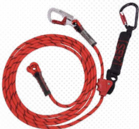
>>> Mitlaufendes Auffanggerät einschließlich beweglicher Führung. Das Verbindungsmittel besteht aus einem kantengeprüftem Kernmantelseil (Ø 12mm), Seilkürzer, Bandfalldämpfer und 2 Karabinerhaken nach DIN EN 353-2:2002 & DIN EN 358:2000. Bis 140kg.
