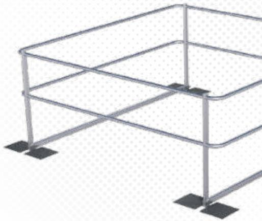
>>> Hochwertiges Schutzgeländer aus Aluminium und Edelstahl für Lichtkuppeln auf Flachdächern bis 10° Neigung. Durchdringungsfreie Montage auf Bitumenbahnen. Höhe des Handlaufs: 1100mm. Inkl. Befestigungsset.
