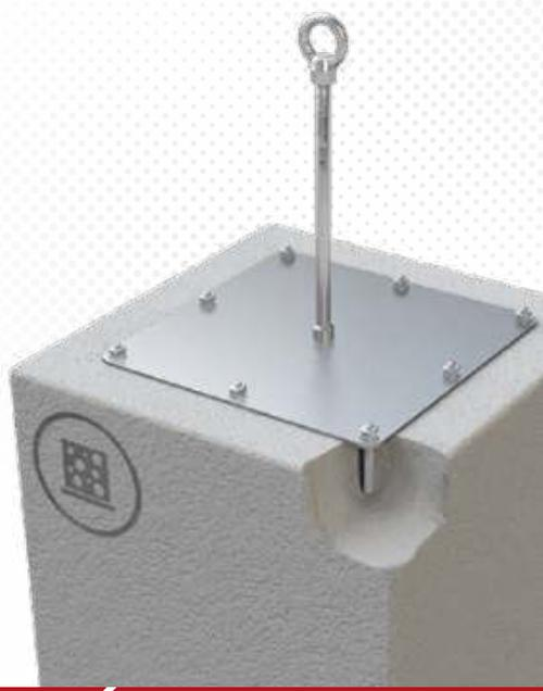
>>> Edelstahl-Anschlagpunkt (Ø 16mm) für Leichtbeton/Porenbeton, mit Grundplatte (370 x 370mm). 8 Ankerstangen werden mit Verbundmörtel WIT-VM-250 (ZU-1000) im Beton befestigt. Inkl. Befestigungsset aus Edelstahl.
