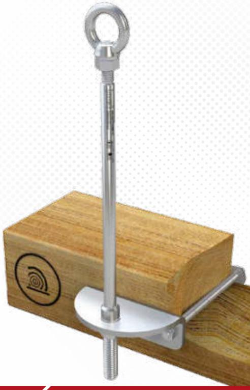
>>> Edelstahl-Anschlagpunkt (Ø 16mm) für Holz, seitliche Montage mit Winkelplatte. 2 Gewindestangen (250mm) werden durch Bohrlöcher gesteckt und mit Muttern gekontert. Inkl. Befestigungsset aus Edelstahl.
