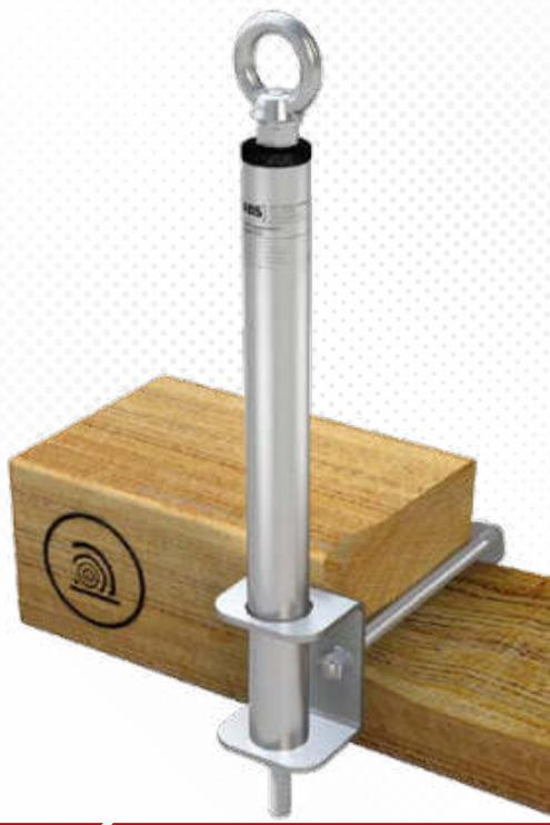
>>> Edelstahl-Anschlagpunkt (Ø 16mm) mit Stützrohr (Ø 42mm) für Holz, seitliche Montage mit Winkelplatte. 2 Gewindestangen (250mm) werden durch Bohrlöcher gesteckt und mit Muttern gekontert. Inkl. Befestigungsset aus Edelstahl.
