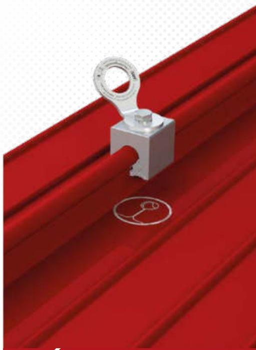
>>> Aluminium-Anschlagpunkt mit Edelstahl-Anschlagöse. Wird durchdringungsfrei am Rundbördelfalz geklemmt. Besonders unauffällig, optimal für den temporären Einsatz. Inkl. Befestigungsset.
