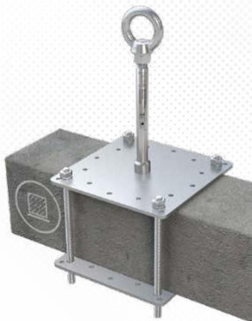
>>> Edelstahl-Anschlagpunkt (Ø 16mm) für Betonträger, mit Grund- und Konterplatte (200 x 200mm). Wird um Träger geklemmt, Trägerbreite max. 150mm. Sondermaße auf Anfrage. Inkl. Befestigungsset aus Edelstahl.
