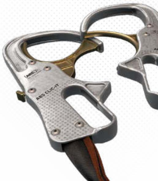
>>> **Persönliche Schutzausrüstung gegen Absturz (PSAgA), Verbindungsmittel 120cm, 2 Karabinerhaken ermöglichen permanente Sicherung. Miteinander kommunizierende Haken, können nicht versehentlich zu gleicher Zeit geöffnet werden. Mobile Lösung für Industrie, Gerüstbau, Windkraft etc. Gewicht unter 2kg.**
