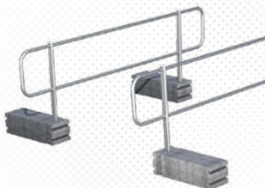
>>> Ermöglicht den sicheren Zugang von der Leiter auf das Flachdach bis in den Nicht-absturzgefährdeten Bereich. Das aus Aluminium und Edelstahl gefertigte Schutzgeländer wird durchdringungsfrei montiert. Inkl. Befestigungsset und 8 Betongewichte.
