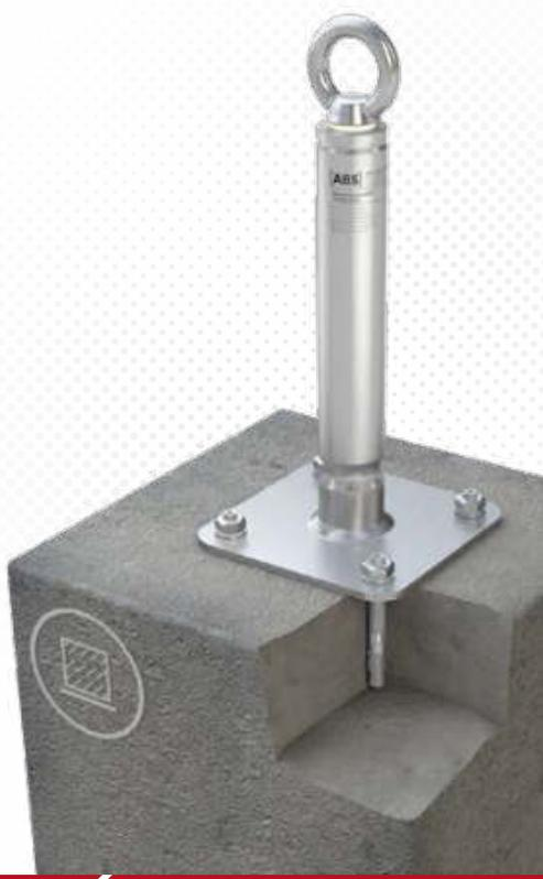
>>> Edelstahl-Anschlagpunkt für Beton, mit Grundplatte (150 x 150mm) und verschweißstem Stützrohr (Ø 42mm). Einfache Befestigung mit 4 Einschlagdübeln. Sondermaße auf Anfrage. Inkl. Befestigungsset aus Edelstahl.
