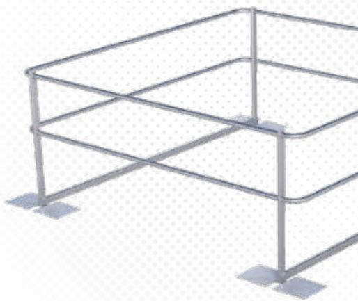
>>> Hochwertiges Schutzgeländer aus Aluminium und Edelstahl für Lichtkuppeln auf Flachdächern bis 10° Neigung. Durchdringungsfreie Montage auf gewebeverstärkter Folie. Höhe des Handlaufs: 1100mm.
