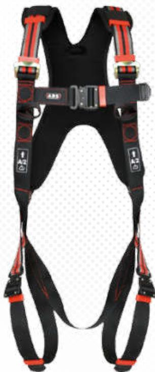
>>> Komfortabler und angenehm leichter Auffanggurt (Einheitsgröße), kann individuell eingestellt werden. 2 Auffangschlaufen im Brustbereich und ein D-Ring im Rückenbereich zur Anbringung geeigneter Verbindungsmittel, z.B. mitlaufendes Auffanggerät ABS Lanyard oder zur Verwendung mit Steigschutzsystemen, z.B. ABS SafetyHike.
