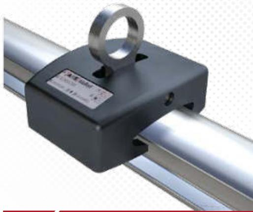
>>> Gleiter aus hochfestem Aluminium und Edelstahl für Schienensicherungssystem ABS AluTrax. Besonders gute Gleiteigenschaften durch kugelgelagerte Rollen. Schienensicherungssystem ABS AluTrax sichert bis 3 Personen zeitgleich (1 Person je Gleiter).
