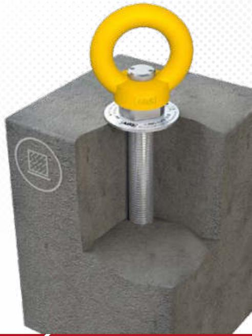
>>> Frei drehbarer Edelstahl-Anschlagpunkt für Wand, Boden, Fassade oder Montage über dem Kopf. Gewinde (M16) 80mm lang. Wird mit Verbundmörtel WIT-VM-250 (ZU-1000) im Beton befestigt. Standardfarbe: Gelb (RAL 1003); weitere Farben (und Preise) auf Anfrage.
