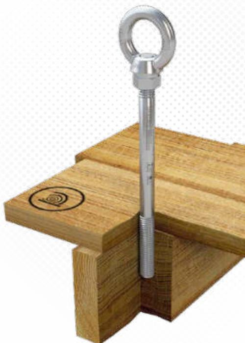
>>> Edelstahl-Anschlagpunkt (Ø 16mm) für Holz. Wird nach Vorbohrung direkt durch die Holzschalung in den Sparren geschraubt.
